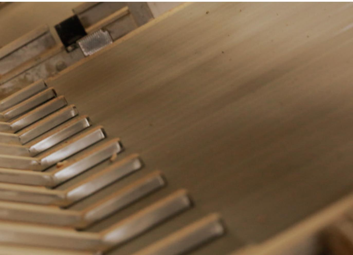
Nel caso che le fette non riuscissero a passare, le telecamere fanno aprire le bandelle a monte ed alzano la struttura dell'allineatore tramite un pistone in modo da riprendere il normale avanzamento delle fette.
